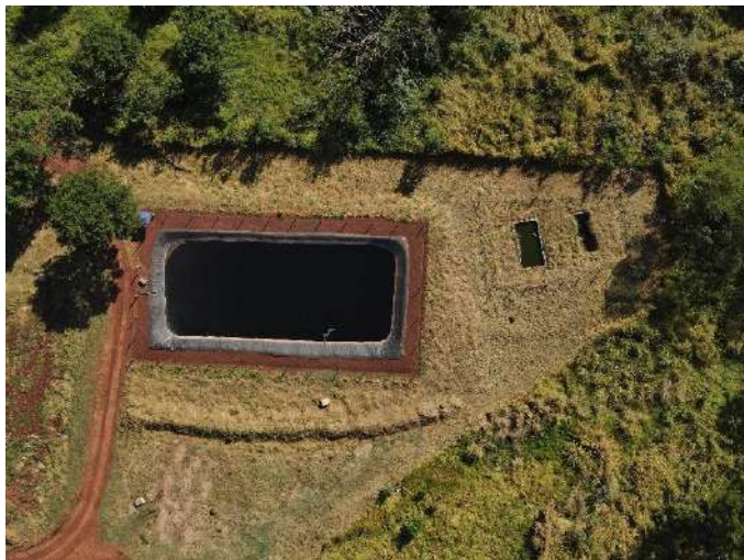
Figura 17 – Lagoa de armazenamento de chorume
