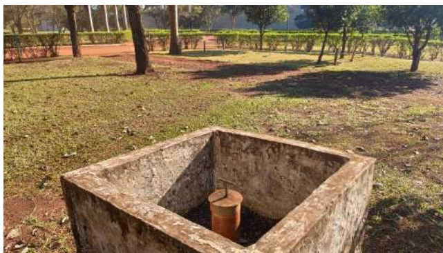
Figura 18 – Piezômetro para o monitoramento
